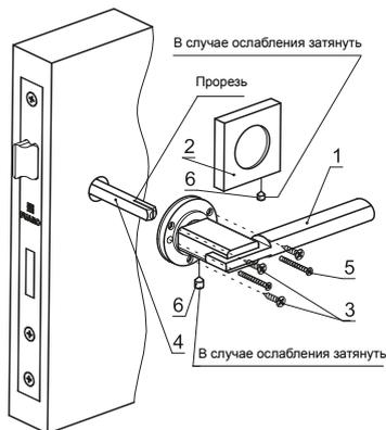
Расположите соединительный квадрат (4) в поворотном гнезде замка. Убедитесь в правильном расположении прорези квадрата. Вставьте ручки (1) с обеих сторон двери. Шилом или керном наметьте центры крепежных отверстий, затяните основания ручек саморезами (3). При наличии в замке сквозных отверстий, соедините основания ручек стяжными винтами (5) для более прочной фиксации на полотне двери. Установите декоративные накладки (2) и затяните фиксирующие винты (6) шестигранниками.
